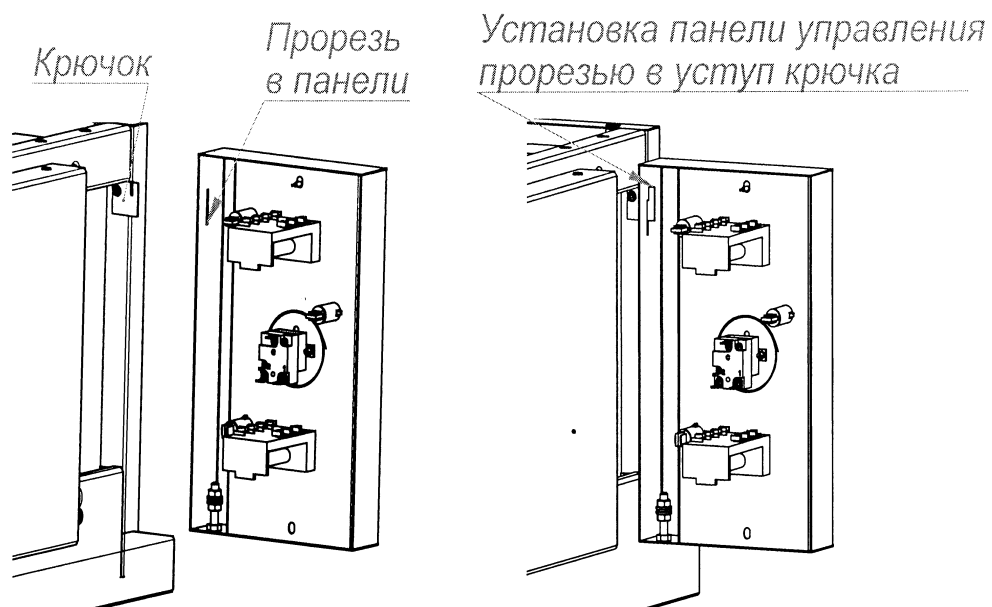
Рис. 4 Схема установки панели управления при ТО
